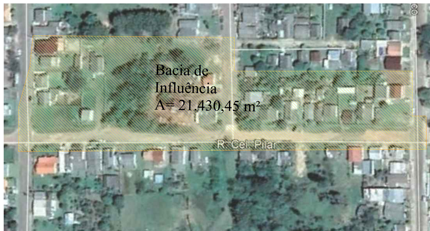
DELIMITAÇÃO DE BACIA - RUA CORONEL PILAR Área da Bacia de Contribuição: 21.430,45 m 2
