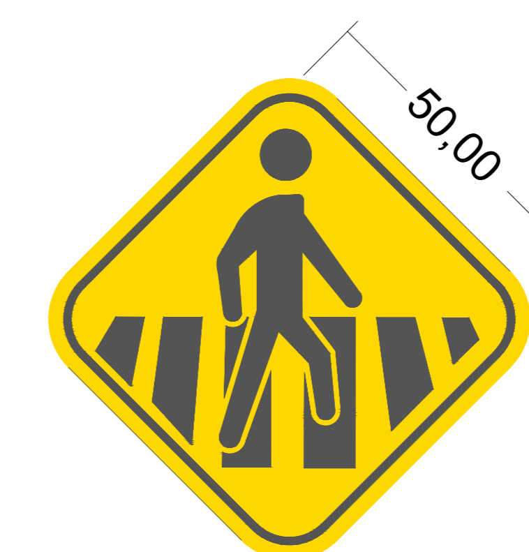
A-32b PASSAGEM SINALIZADA DE PEDESTRES Área= 0,25 m 2
