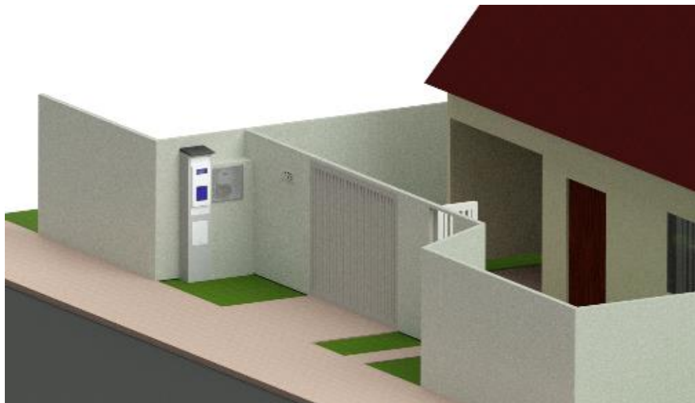
Figura 2 - Padrão pedestal 200 A com medição indireta - Caixa Acoplada
