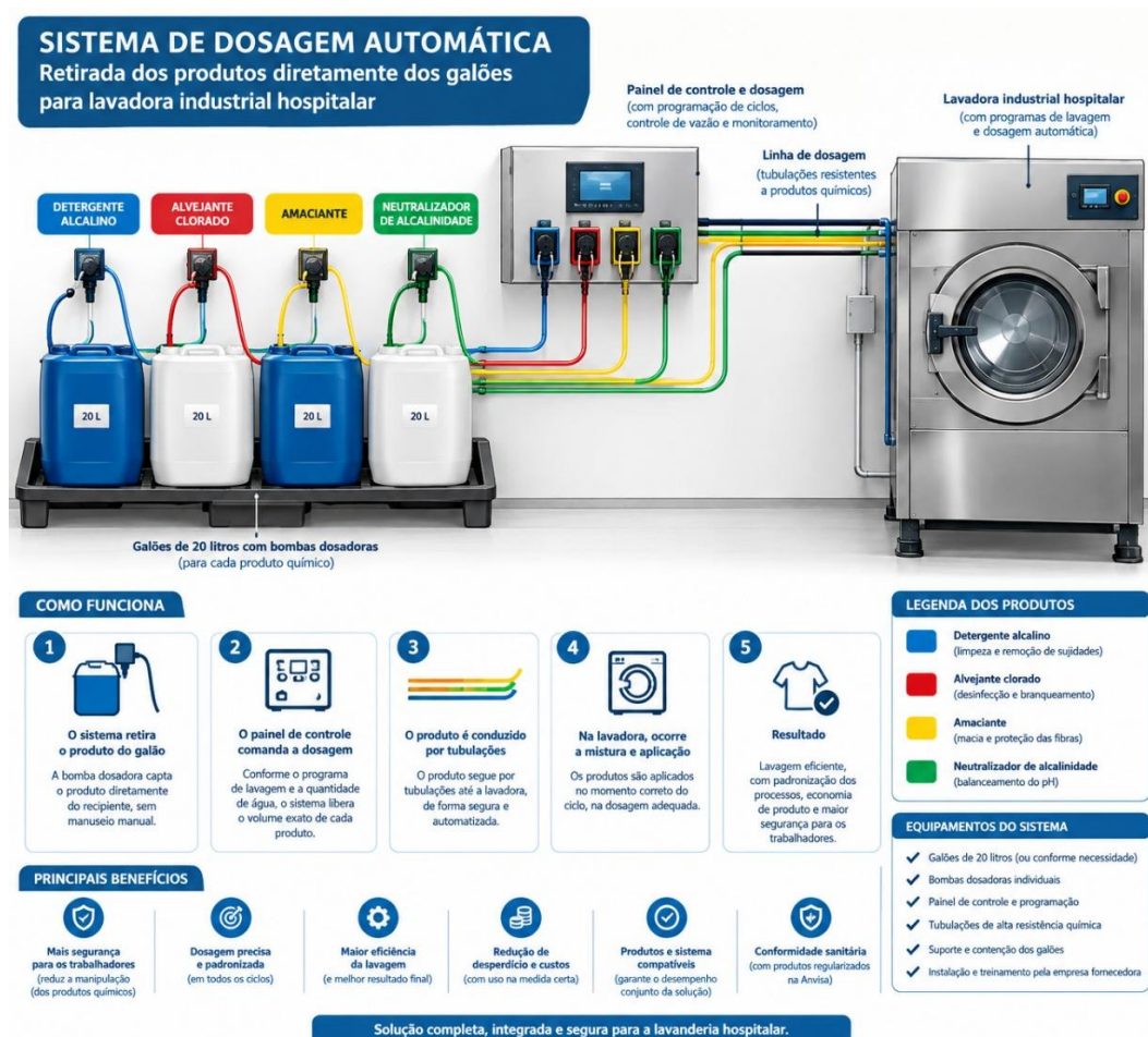
Figura 1 – Esquema ilustrativo da solução de dosagem automática para lavanderia hospitalar.
